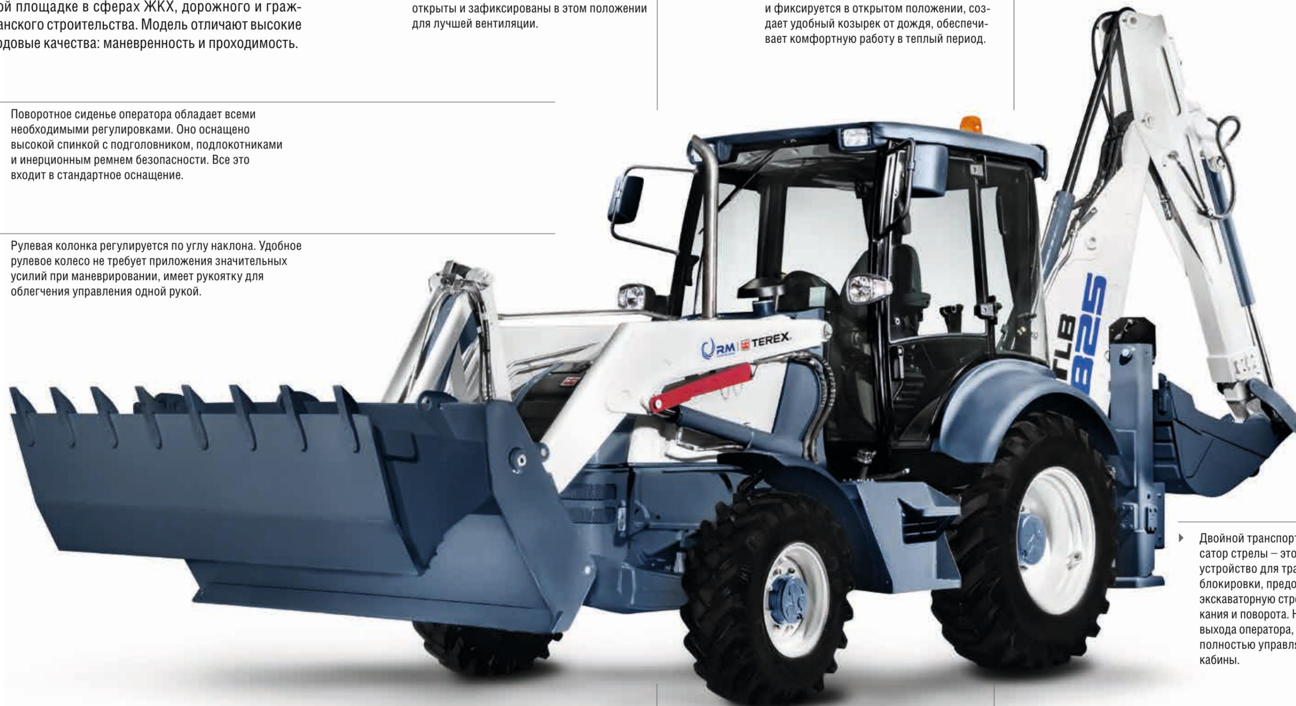
▶ Двойной транспортный фиксатор стрелы – это уникальное устройство для транспортной блокировки, предохраняющее экскаваторную стрелу от опускания и поворота. Не требует выхода оператора, поскольку полностью управляется из кабины.
